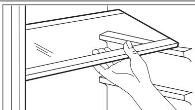
Расположенные на стенах холодильника направляющие позволяют размещать полки на нужной высоте.
