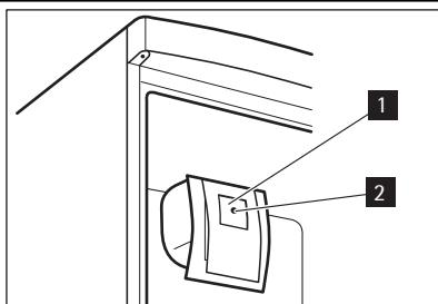
Функция DYNAMICAIR позволяет быстрее охлаждать продукты и поддерживать в холодильнике более равномерную температуру. Для включения DYNAMICAIR нажмите на выключатель (1). Загорится зеленый индикатор (2).
