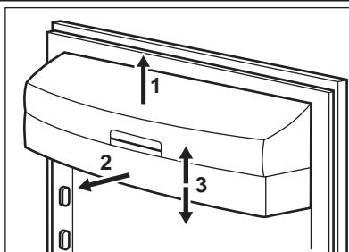
Чтобы обеспечить возможность хранения упаковок продуктов различных размеров, полки дверцы можно размещать на разной высоте. Чтобы переставить полку, действуйте следующим образом: медленно потяните полку в направлении, указанном стрелками, пока она не освободится; затем установите ее на нужное место.
